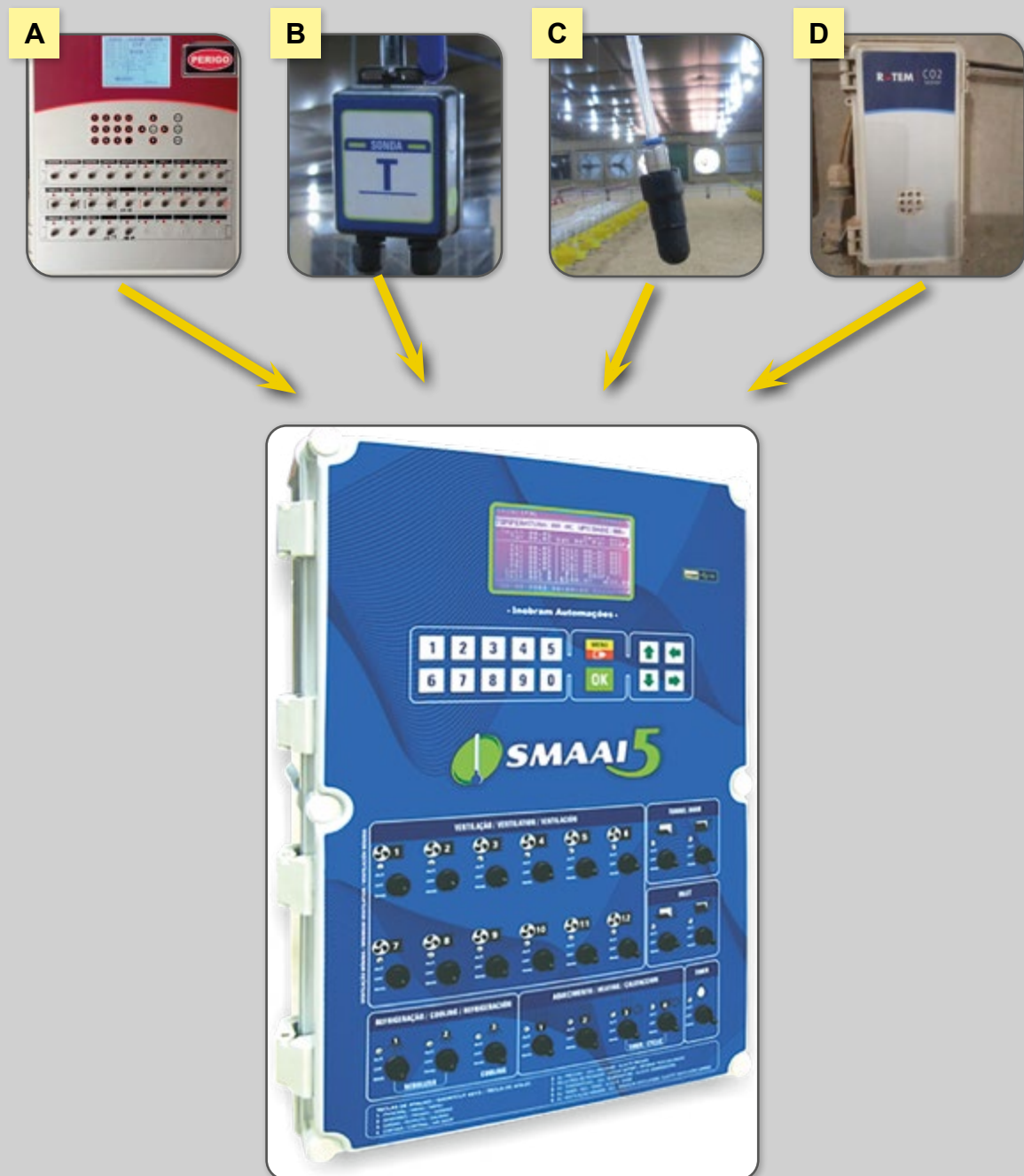
Figura 43 – Representação da interação entre sensores de A) Umidade; B) Temperatura; C) Pressão; D) CO 2 .
