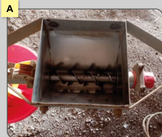
Figura 83 – Linha secundária: A) Moega; B) Extensão da linha secundária; C) Comedouro intermediário; D) Motor e comedouro controle.
