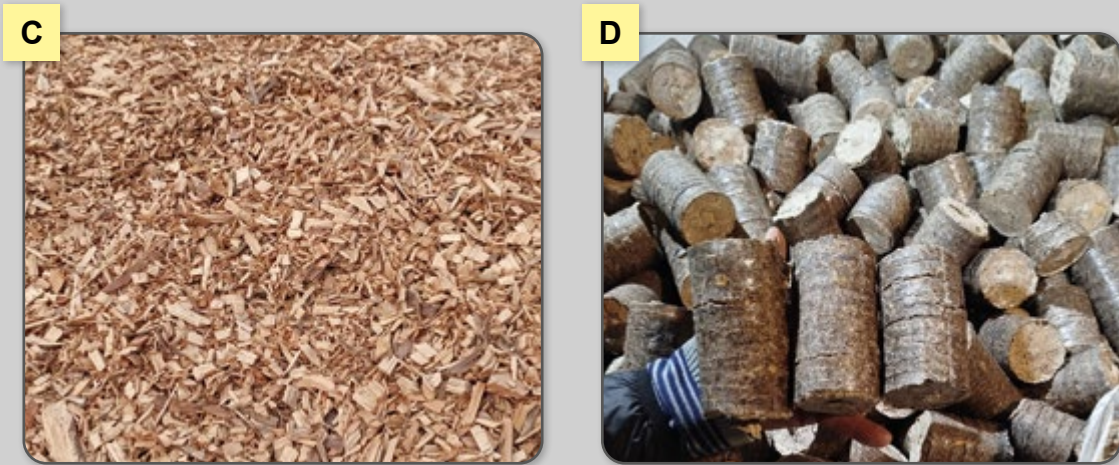
Figura 65 – Matérias-primas utilizadas em fornalhas: C) Cavaco; D) Briquete.
