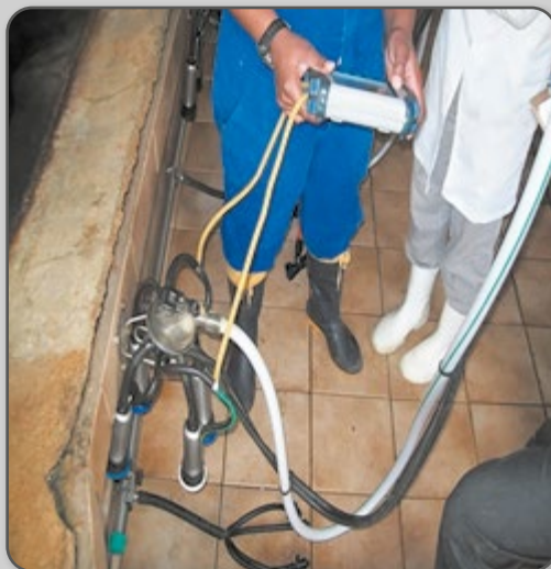
Figura 22 – Avaliação dos equipamentos de ordenha com pulsógrafo digital.
