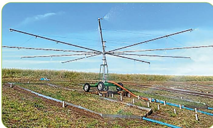
**Figura 13** – Simulador de chuvas de braços rotativos do tipo empuxo utilizado no estudo em microparcelas recobrimdo duas unidades experimentais, simultaneamente.
