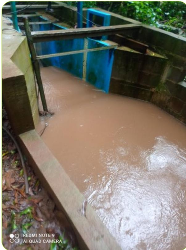
**Figura 21** – Seção de monitoramento com calha Parshall durante a recessão do evento do dia 11/10/2022 da bacia hidrográfica de primeira ordem de Toledo-PR
