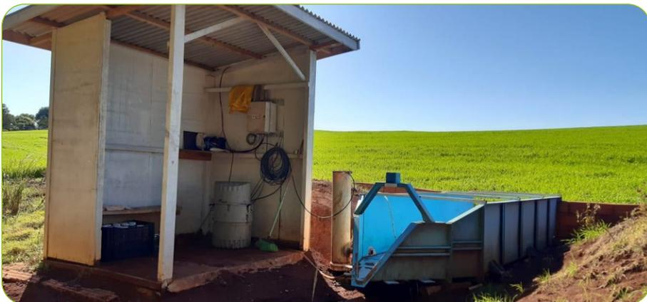
**Figura 12** – Seção de monitoramento com amostrador automático de sedimentos junto à calha H em Toledo-PR
