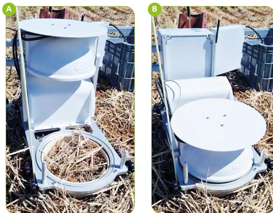
**Figura 23** – Medidor de fluxo de  $\text{CO}_2$  com a câmara aberta (a) e fechada realizando a medição no campo (b). Distrito de Entre Rios, Guarapuava-PR
