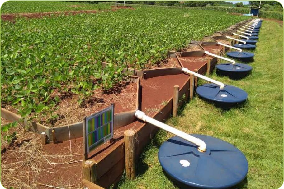
**Figura 12** – Visão das parcelas com aplicação de dejetos, delimitadas por calhas de aço galvanizado com caixa de armazenamento do escoamento superficial, cultivadas com soja, Dois Vizinhos-PR
