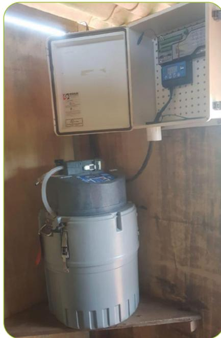
**Figura 8** – Amostrador automático de sedimentos (ISCO®) instalado na bacia hidrográfica experimental de primeira ordem em Toledo-PR
