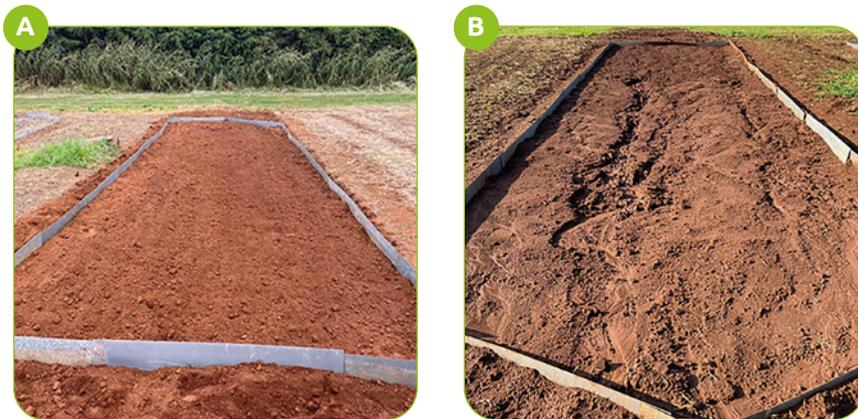
**Figura 15** – Imagens da parcela com o tratamento solo sem cobertura (SSC – testemunha) antes (A) e depois (B) da aplicação de chuva simulada, em Ponta Grossa-PR.
