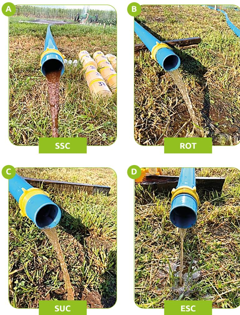
**Figura 16** – Imagem do escoamento superficial e da concentração de sedimentos no fluxo para os diferentes tratamentos durante chuva simulada realizada no cultivo de verão, em Ponta Grossa-PR. A coloração mais escura reflete a maior quantidade de sedimentos transportados. A) SSC: solo sem cobertura vegetal; B) ROT: plantio direto com rotação de culturas; C) SUC: plantio direto com sucessão de culturas; D) ESC: plantio direto com sucessão de culturas e solo escarificado.
