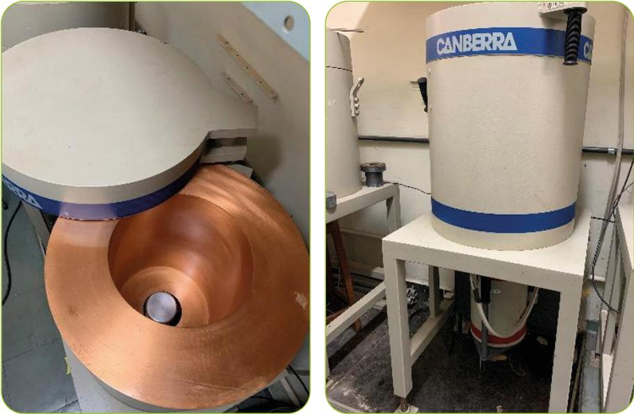
**Figura 32** – Sistema de detecção utilizado: detector HPGe e blindagem de chumbo
