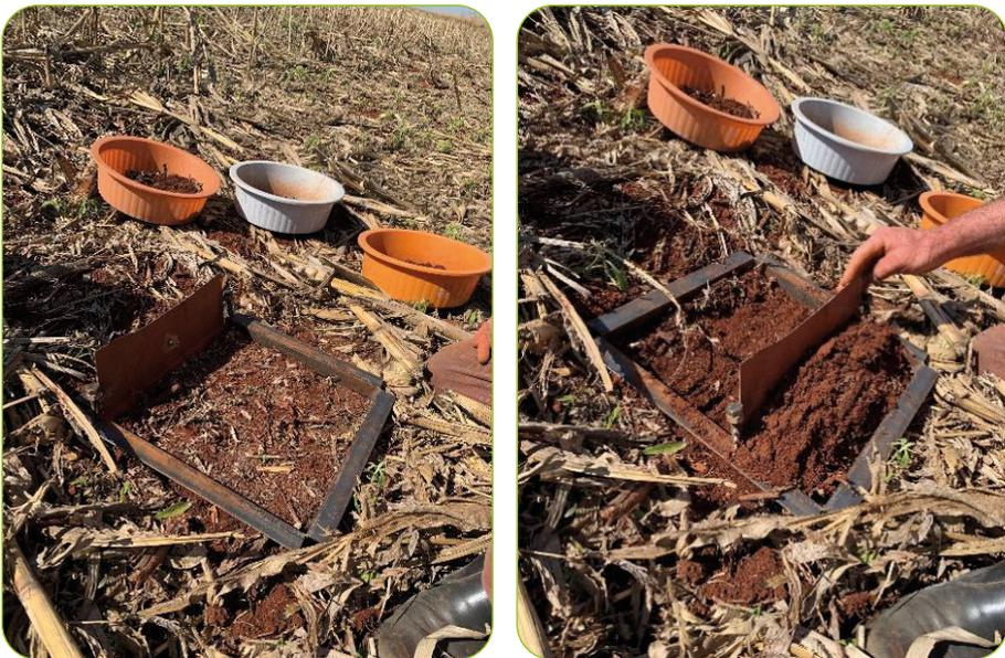
**Figura 30** – Sistema de coleta de amostra nas megaparcelsas, Cambé-PR
