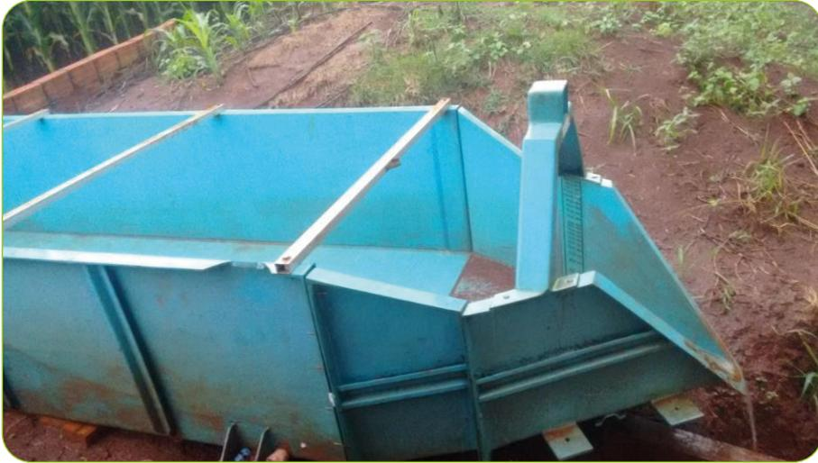
**Figura 11** – Seção de monitoramento com calha H em Toledo-PR
