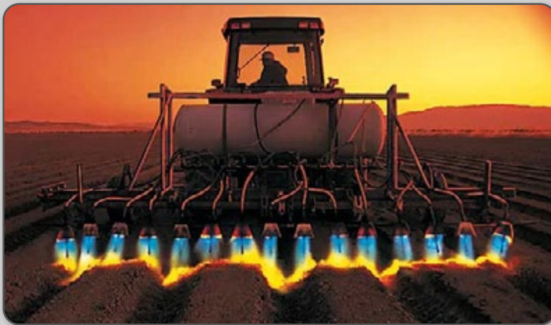
Figura 24 – Equipamento para aplicação de fogo para o controle de plantas daninhas. Red Dragon® Vegetable Bed Flamers.
