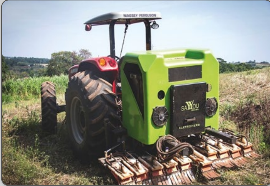
Figura 23 – Aplicação de eletricidade no controle de plantas daninhas.
