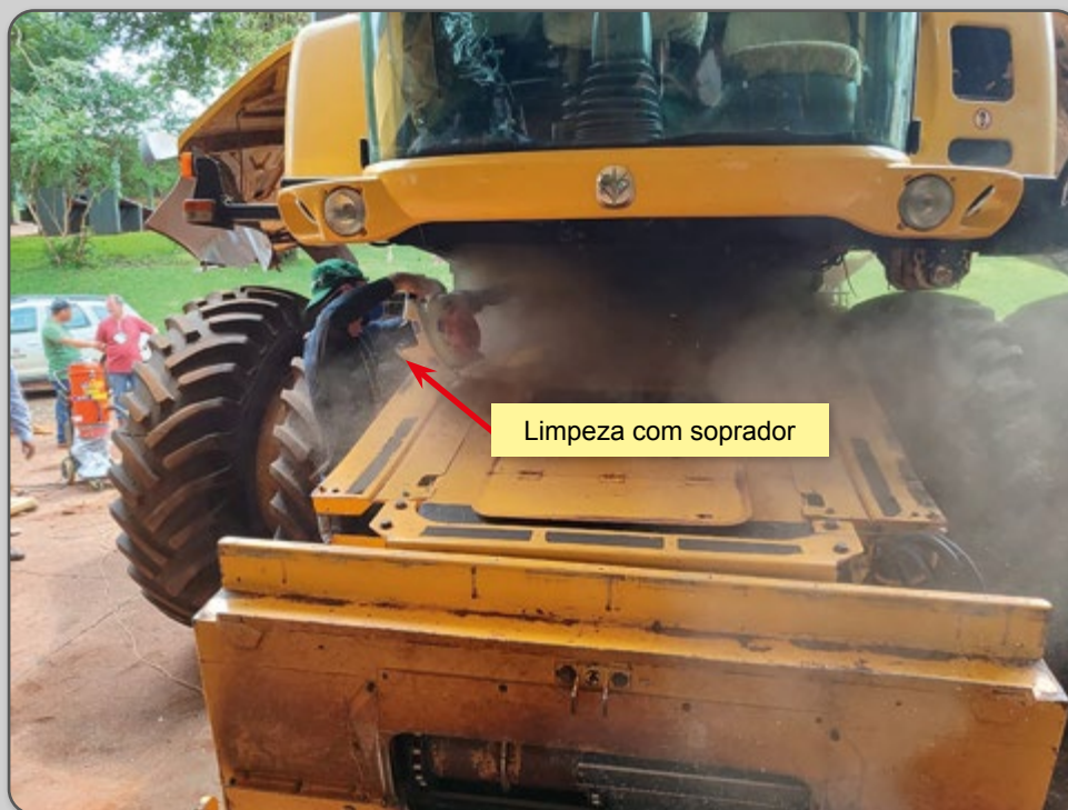
Figura 7 – Limpeza da porção frontal do rotor/cilindro com soprador.
