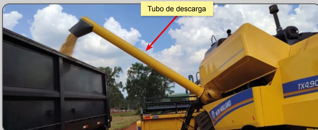
Figura 5 – Acionamento do tubo de descarga para remoção de resíduos do tanque graneleiro.
