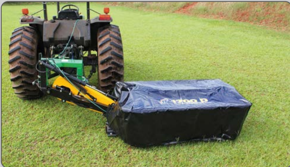
Figura 12 – Ceifadora de discos com proteção.
