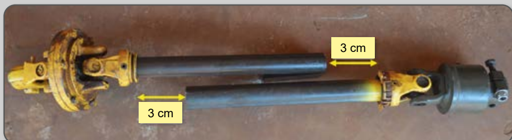
Figura 23 – Partes do eixo cardã com folga de 3 cm em ambos os lados.
