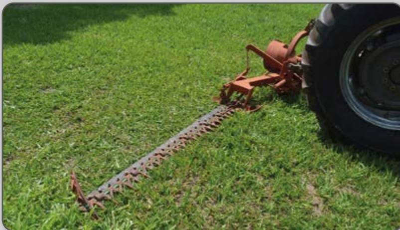
Figura 3 – Barra de corte em posição de trabalho.
