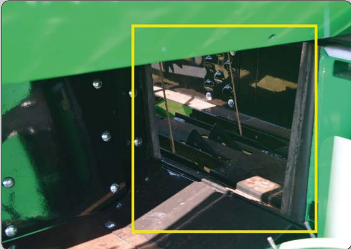
Figura 68 – Janela de alimentação no canal compactador.
