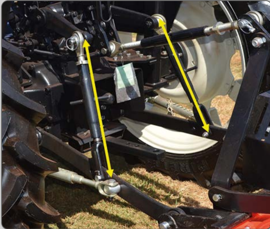
Figura 29 – Medição para nivelamento transversal.
