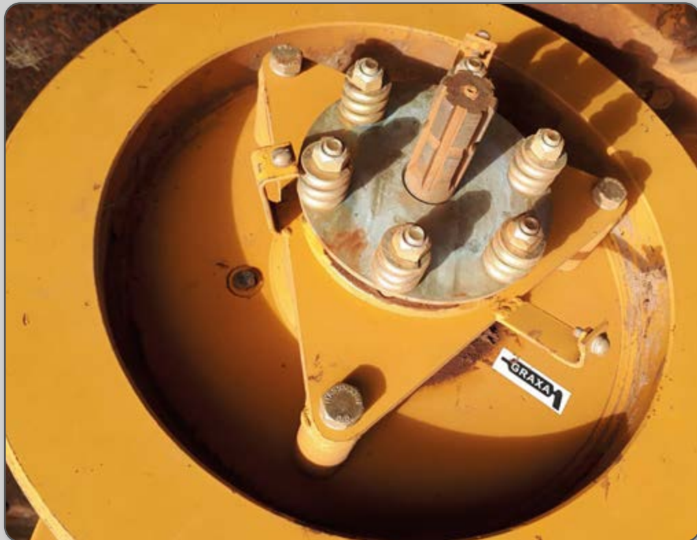
Figura 102 – Manutenção periódica com graxa.
