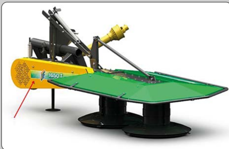
Figura 45 – Proteção ao redor das correias.
