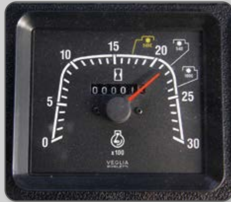
Figura 37 – Painel de instrumentos do trator com diferentes possibilidades de rotação da TDP.
