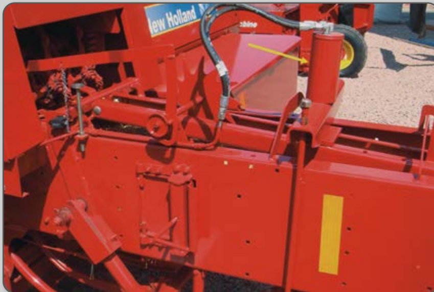
Figura 91 – Mecanismo hidráulico para compactação do fardo.
