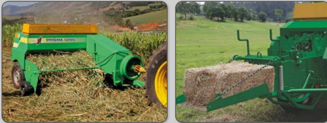
Figura 53 – Enfardadora de fardos retangulares recolhendo a forragem e produzindo o fardo.
