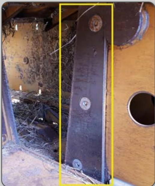
Figura 69 – Faca na lateral do êmbolo.
