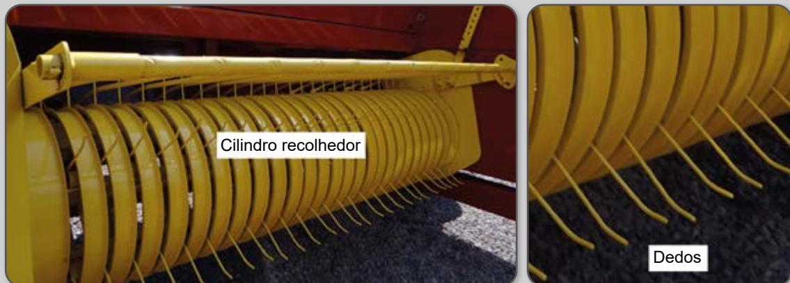
Figura 54 – Mecanismo de cilindro recolhedor, com detalhe dos dedos.
