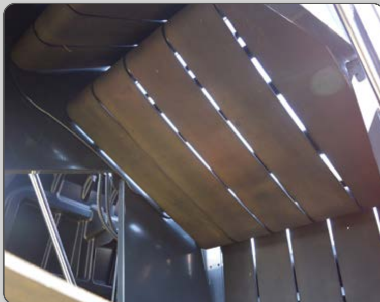
Figura 94 – Correias paralelas independentes.
