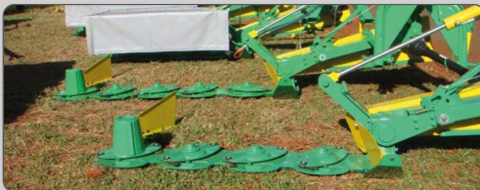
Figura 14 – Ceifadora de discos com e sem proteção dos mecanismos de corte.
