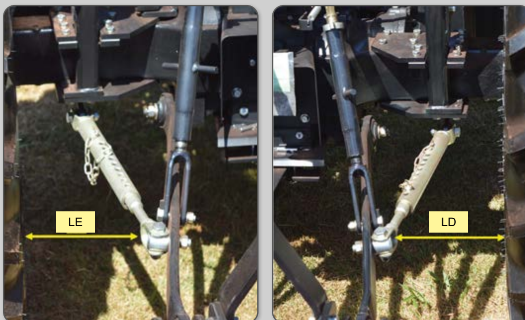
Figura 28 – Medidas iguais dos dois lados garantem o alinhamento.
