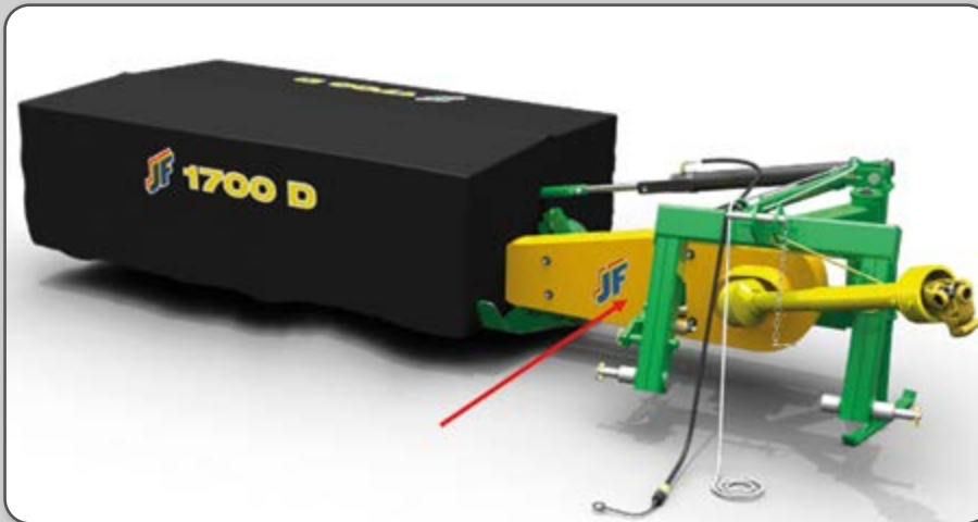
Figura 25 – Proteção ao redor das correias.
