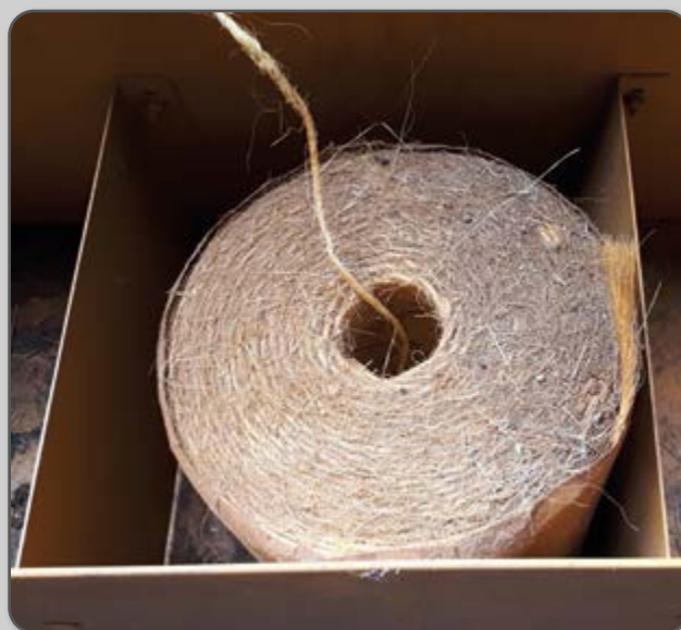
Figura 71 – Exemplo de material para amarração de fardos (sisal).
