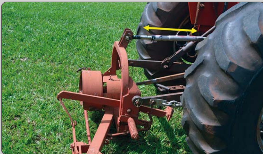
Figura 30 – Medição para nivelamento longitudinal.
