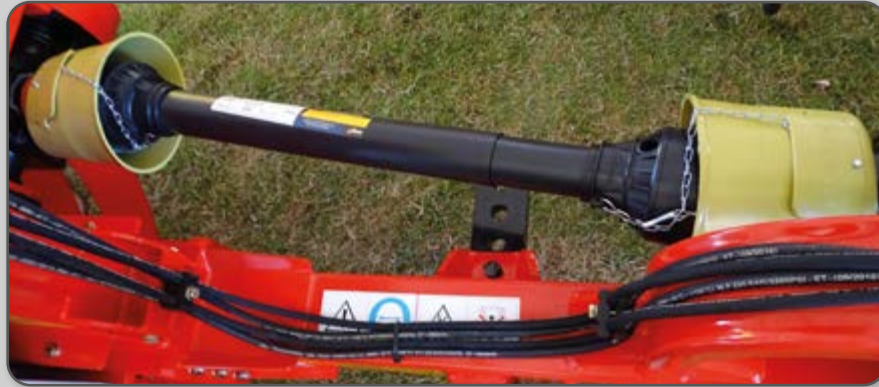
Figura 85 – Eixo cardã com proteção.
