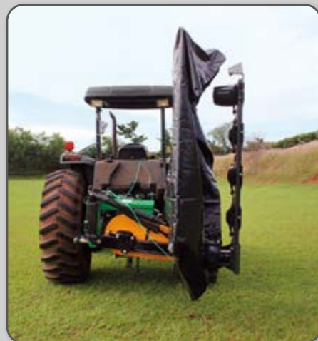
Figura 38 – Ceifadora na posição de trabalho (esquerda) e de transporte (direita).
