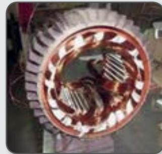
f) Colocação bobinas no motor trifásico.
