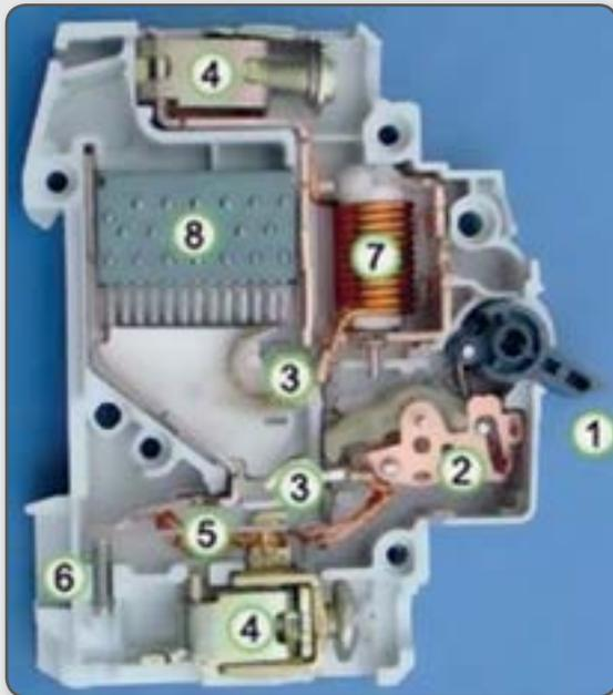
1. Manopla ou alavanca: para fazer o fechamento ou a abertura manual do disjuntor. Também indica o estado do disjuntor ligado (vermelho visível), desligado ou desarmado (verde visível). A maioria dos disjuntores são projetados de forma que o disjuntor desarme mesmo que a manopla seja travada na posição “ligado”.
