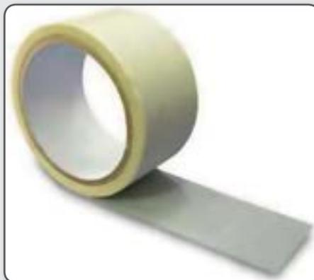
A fita auto-fusão protege até 69.000 Volts. Isola contra umidade, mas não resistem a ações mecânicas, são frágeis, portanto deve-se recobrir com fita de PVC. Não retirar o filme protetor da fita auto-fusão antes de isolar.
