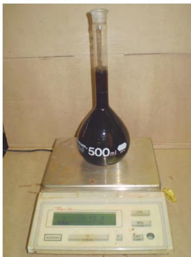
**Figura 2.** Determinação da densidade do DLS, em balão volumétrico, em laboratório.
