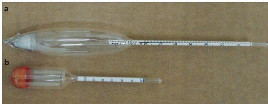
**Figura 4.** a) Bouyoucos, com escala de 1 g/L a 60 g/L. b) Densímetro, com escala de 1,000 g/L a 1,060 g/L.
